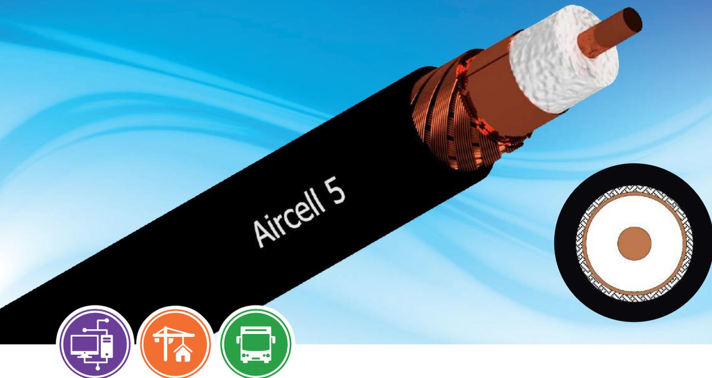
Aircell 5 ist ein fünf Millimeter dünnes, flexibles Koaxialkabel für den Frequenzbereich bis 10 GHz. Die im Verhältnis zum Durchmesser sehr niedrige Dämpfung und die alternative Verwendbarkeit von RG-58 Standard-Koaxialverbindern machen dieses Kabel nicht nur für Wireless-LAN, sondern für viele Anwendungen in der Nachrichtentechnik zur ersten Wahl.
