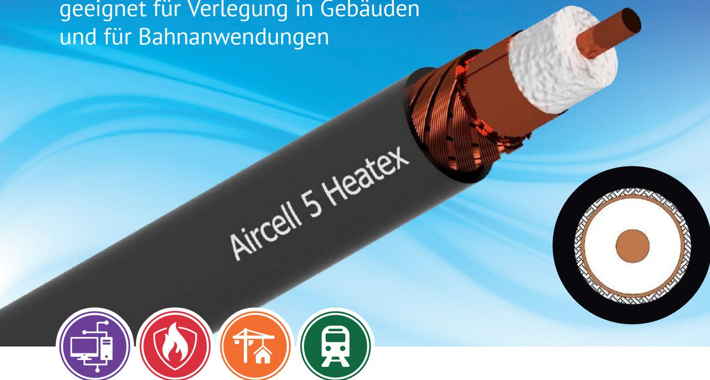
Aircell 5 Heatex ist ein dünnes, flexibles Koaxialkabel für den Frequenzbereich bis 10 GHz. Die sehr niedrige Dämpfung und die alternative Verwendbarkeit von RG-58 Standard-Koaxialverbindern machen dieses Kabel für viele Anwendungen in der Nachrichtentechnik zur ersten Wahl.
